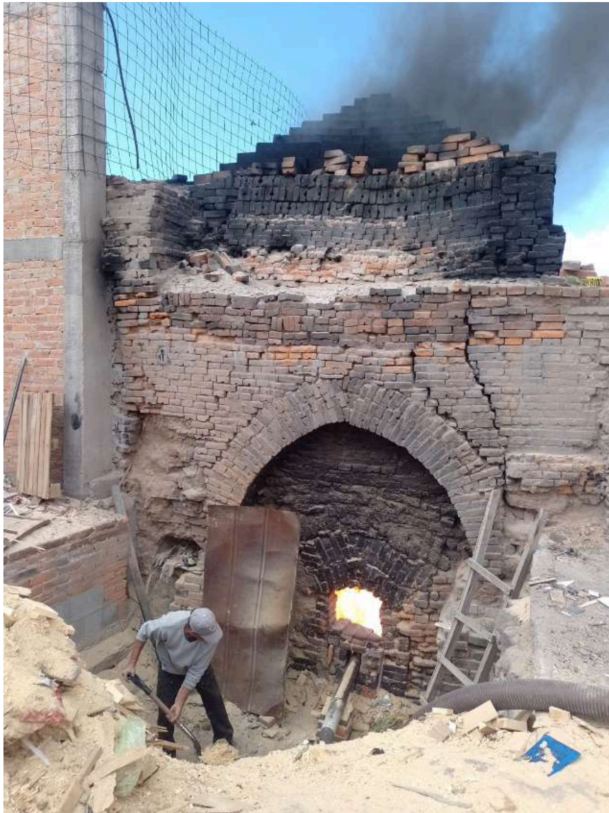
Figura 4. Quemando el ladrillo. Las Terceras, San Luis Potosí. 2024. Fotografía del autor
