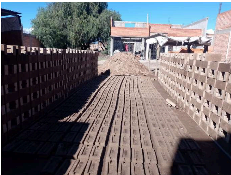
Figura 3. Ladrillo tendido y “amonado”. Las Terceras, San Luis Potosí. 2024. Fotografía del autor
